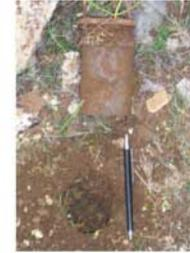
Detalle de un electrodo impolarizable
